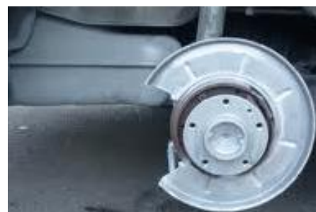
Résultat après 650 heures en ambiance saline agressive humide à 35 °C
