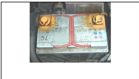
Batterie : après application de la protection sur les bornes et connexions : celles-ci conserve un coloration jaune, pas de fuite d'acidité bonne protection et isolation
