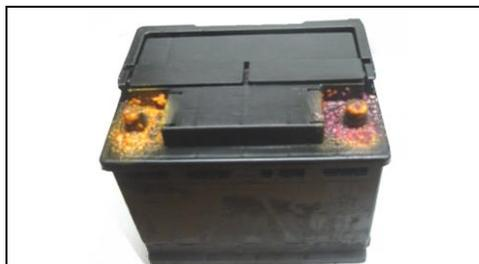
Batterie non protégée : après application de la protection sur les bornes et connexions une coloration rouge apparaît ( fuite d'acidité )
