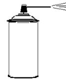
. Pour des raisons de sécurité et bien que la rigidité diélectrique soit supérieure à 30000 volts, prendre la précaution de mettre le matériel **HORS tension**.
